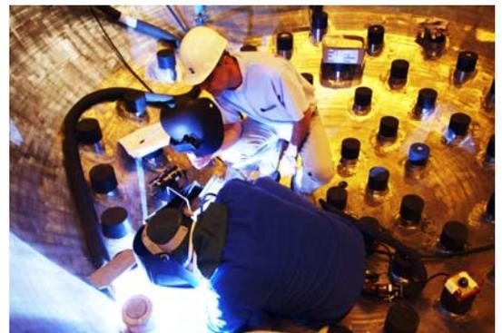
*L'inspecteur assiste aux opérations de fabrication et surveille le respect des exigences du client (soudage des adaptateurs de couvercles de cuve)*
